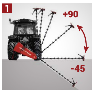
1 POSITION DE TRAVAIL Sur terrains en pente jusqu'à +90 / -45 degrés
