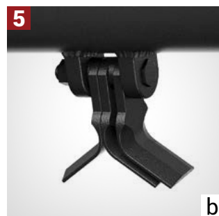
OPTIONS DE COUPEAU a) Marteau-couteau (standard) - pour des conditions de travail plus difficiles (branches, mauvaises herbes plus épaisses, herbe, etc.); b) Couteau universel en Y (en option) - pour des conditions de travail plus faciles (herbe, mauvaises herbes, etc.)
