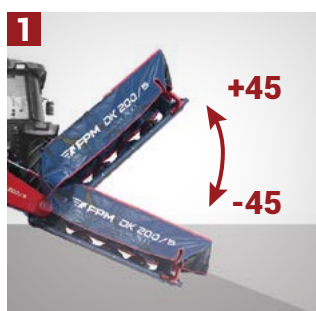
1 POSITION DE TRAVAIL Sur terrains en pente jusqu'à +45 / -45 degrés
