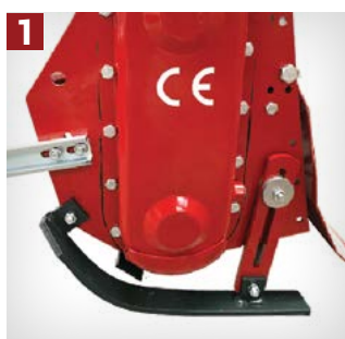
RÉGLAGE DE LA PROFONDEUR DE TRAVAIL En utilisant les patins latéraux
