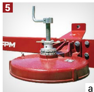
5 RÉGLAGE DE LA HAUTEUR DE TRAVAIL: a) en ajustant la hauteur au-dessus de la tête cinématique;
