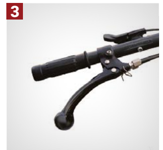
3 FREINS MÉCANIQUES Pour les deux points simultanément ou séparément pour chacun; Option avec différentiel pour tous les modèles
