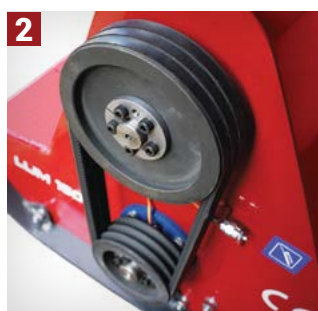
2 TRANSMISSION LATÉRALE Sur un jeu de courroies trapézoïdales dentelées spéciales
