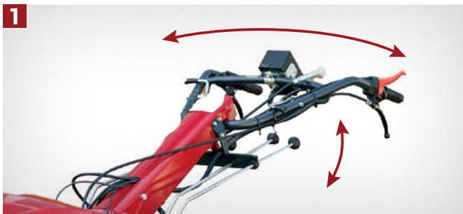
1 VOLANT Réglable en hauteur, sur 6 positions et sur le côté à 180 degrés
