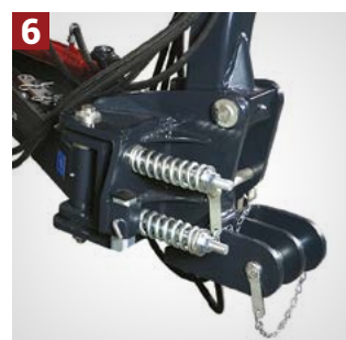
6 MÉCANISME DE SÉCURITÉ Avec ressorts, permet le déplacement actuel du broyeur latéral en cas de collision avec un obstacle. Cela vous permet de franchir l'obstacle en toute sécurité
