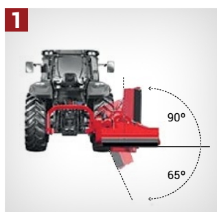
1 DÉPLACEMENT VERTICAL De -65 degrés à +90 degrés
