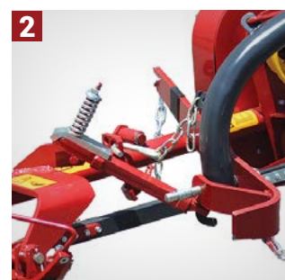
STRUCTURE DU CADRE Système de sécurité pour le déclenchement automatique du dispositif de coupe en cas d'obstacle
