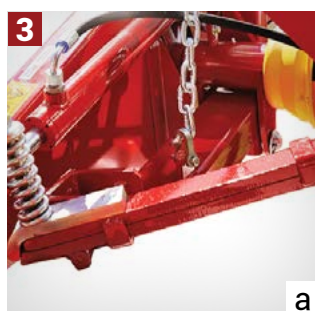
3 STRUCTURE DU CADRE a) Système de sécurité pour le déverrouillage automatique du dispositif de coupe en cas d'obstacle; b) Système de levage hydraulique (en option)
