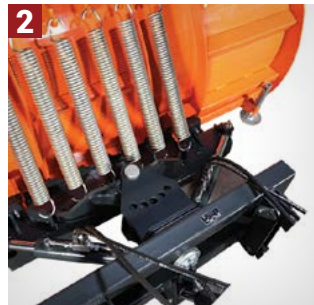
2 SYSTÈME D'AMORTISSEMENT Frappe en rencontrant un obstacle
