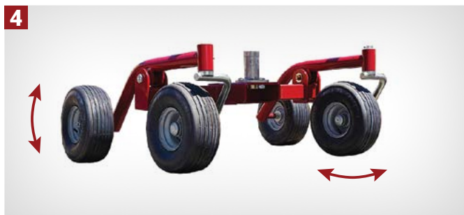
4 OPTIONS EN 4 POINTS: MOUVEMENT VERTICAL DES ROUES Pour +/- 10 degrés permet une meilleure suivie du terrain, la possibilité de faire tourner la première paire de roues, ce qui permet de changer le sens de déplacement sans soulever la machine
